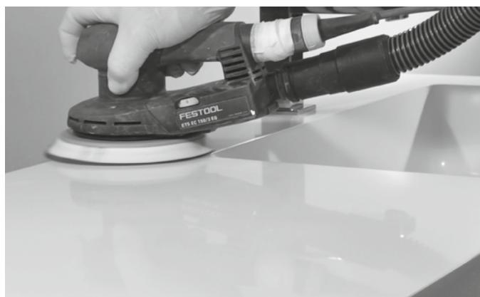
Le stesse operazioni possono essere fatte con una levigatrice orbitale, raggiungendo velocemente un grado di finitura massimo.
