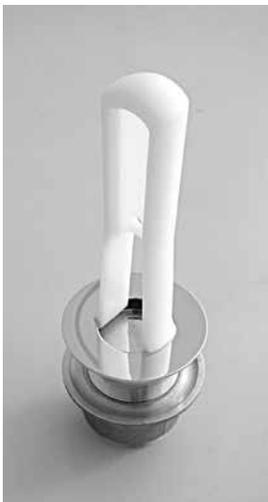
Pinza in nylon per lo smontaggio della piletta con troppo pieno automatico, necessaria per la manutenzione e pulizia.
