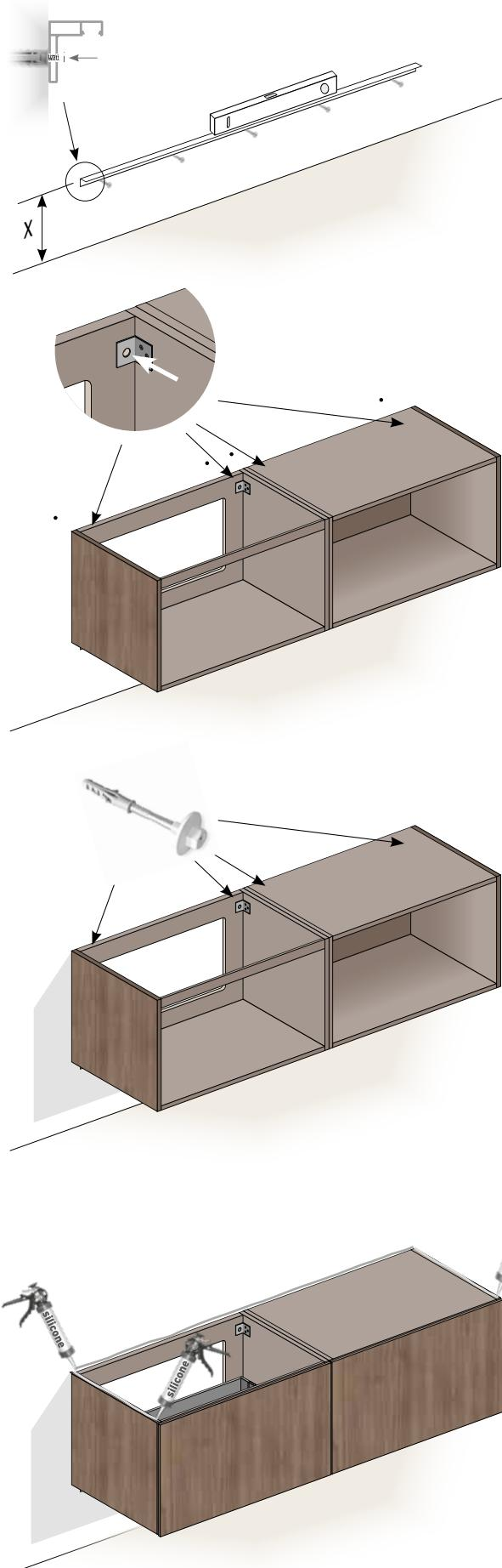
**Montaggio mediante squadretta e barra di sostegno a "L"**
