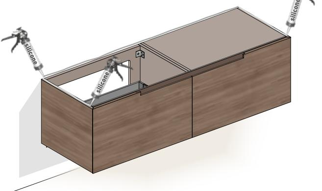
**Montaggio mediante squadretta e barra di sostegno a "L"**
