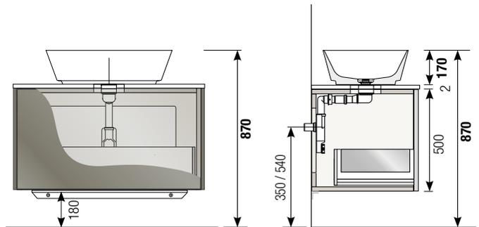
Lavabo incasso totale su base con cassetto. In abbinamento al sifone S.SPA01 o S.SPA02. **Lo schema a lato è calcolato con un lavabo H 17 cm e un'altezza complessiva da terra di 87 cm.**
