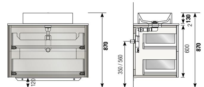
Lavabo incasso totale su base con cassetto. In abbinamento al sifone S.SPA01 o S.SPA02. **Lo schema a lato è calcolato con un lavabo H 17 cm e un'altezza complessiva da terra di 87 cm.**
