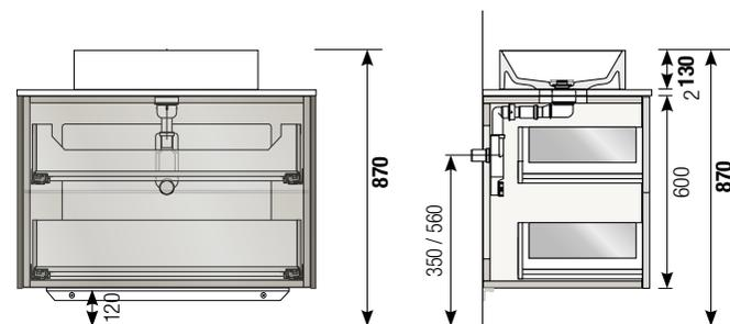
Lavabo incasso totale su base con cassetto. In abbinamento al sifone S.SPA01 o S.SPA02. **Lo schema a lato è calcolato con un lavabo H 17 cm e un'altezza complessiva da terra di 87 cm.**
