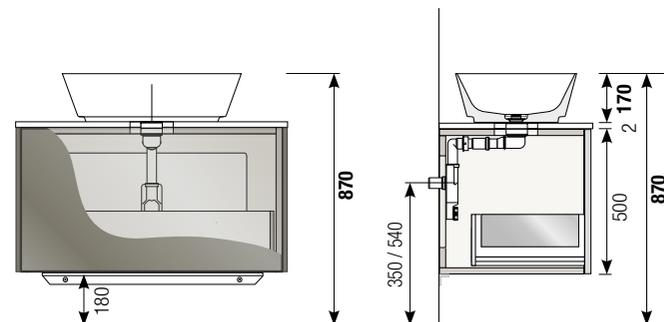
Lavabo incasso totale su base con cassetto. In abbinamento al sifone S.SPA01 o S.SPA02. **Lo schema a lato è calcolato con un lavabo H 17 cm e un'altezza complessiva da terra di 87 cm.**
