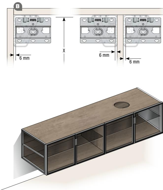
Montare la barra di sostegno a "L" perfettamente orizzontale all'altezza prevista in base all'elemento da fissare alla parete
